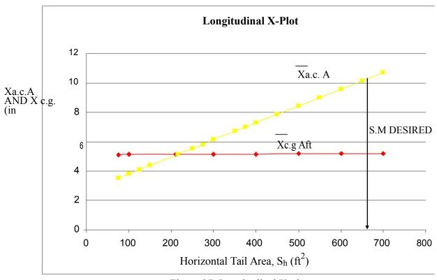
Figure 37. Longitudinal X-plot
